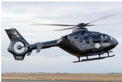
Modèle-phare de la firme Eurocopter, l' EC 135 remplace peu à peu les Écureuils au sein des escadrons de la Gendarmerie Nationale. Doté de deux turbines développant 780 CV chacune, de commandes de vol électriques, d'une tête de rotor sophistiquée à quatre pales , d'un rotor anti couple logé dans un fenestron, il représente ce qui se fait de mieux en matière d'hélicoptères polyvalents. Adapté aussi bien à un usage civil que militaire, son domaine d'utilisation est très
