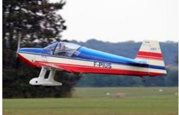
à la voltige, possède une aile sans dièdre en carbone, des gouvernes puissantes et est mû par un moteur de 180 ou 200 CV selon les versions. Il permet de passer toute la voltige académique (premier et second cycle) et constitue une porte d'entrée vers les monoplaces surpuissants qui permettent de concourir dans les grandes compétitions internationales. Simon présente donc un programme libre sur cet appareil qui démontre à la fois les capacités du pilote et celles de la machine.
