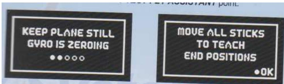
La Mercury SRS effectue une auto-calibration des capteurs gyroscopiques et réinitialise le déplacements maximum des surface de contrôle. Dans l'écran d'affichage suivant vous êtes invité à déplacer tous les manche de l'émetteur. Lorsque vous avez fait cela, confirmez en sélectionnant OK.
