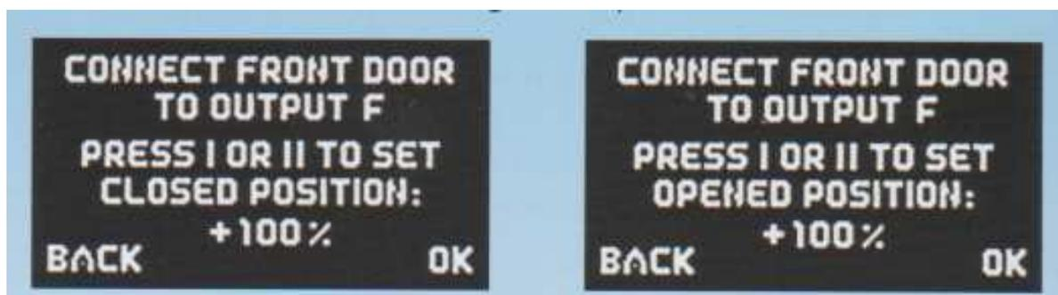
Connectez le servo de la 1ere trappe AV à la sortie F.
