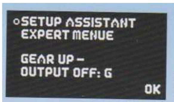
Le SETUP ASSISTANT vous aide à ajuster la séquence des trappes du train rentrant en seulement quelques minutes.
