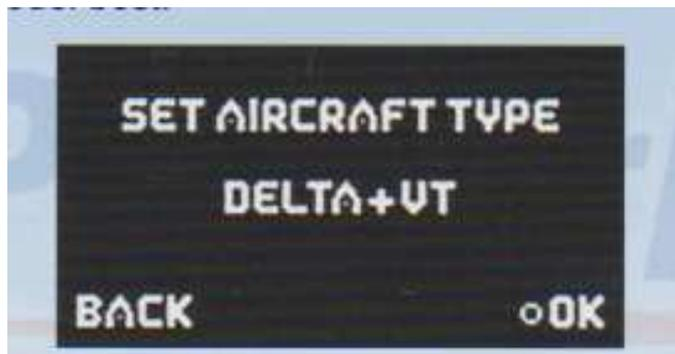
Les sorties sont éteintes dans les modes de vol 1 et 2. Cela vous permet de contrôler un jet avec poussée vectorielle en utilisant seulement trois canaux, sans avoir à mettre en place des mixages à l'émetteur. Vous avez seulement besoin de mettre en place des ailerons, de la profondeur et de la direction à l'émetteur; le contrôle du vecteur de poussée est alors allumé en vol mode 3.
