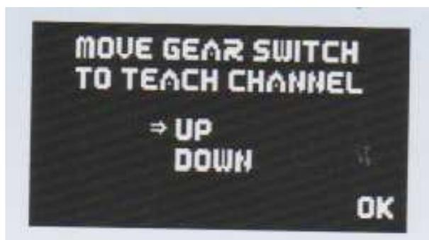
Actionner l'interrupteur de l'émetteur approprié, et la PowerBox détecte automatiquement le commutateur auquel vous avez attribué le train rentrant Les flèches à l'écran devraient maintenant être situés en face de UP / DOWN
