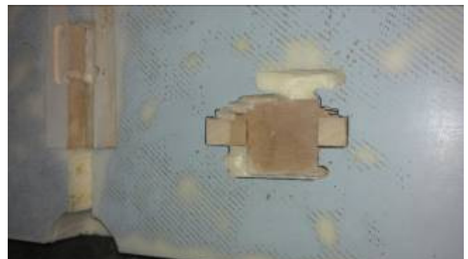
13 -Coller la fixation du servo dans son logement.
