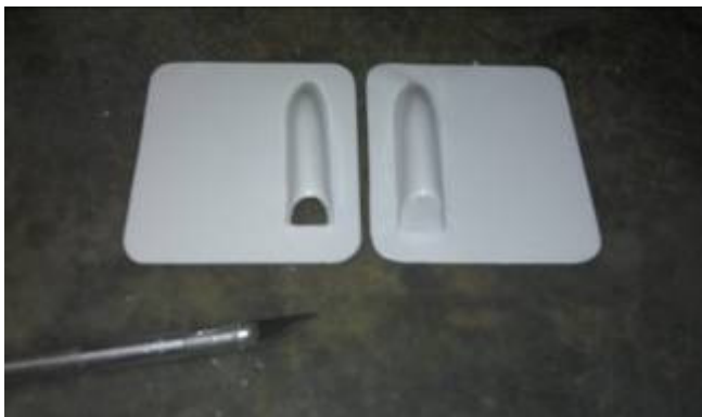
16 -Découper la sortie du cache de servo pour laisser passer la tringle. La partie découpée est en exemple sur le cache de gauche
