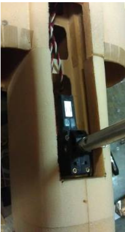
17 -Enfiler la cellule avant et ajuster si nécessaire les plans de collage.
