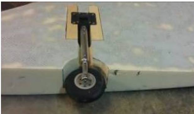
11 -Encastrer le mécanisme de train rentrant et ajuster si besoin.
