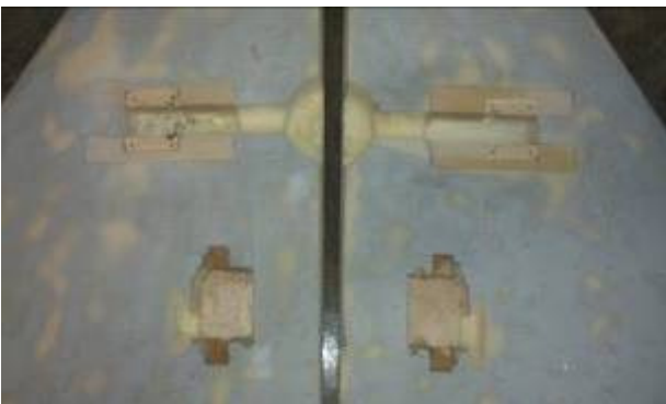
14 -Effectuer de même pour la seconde aile et s'arranger pour que les découpes soient symétriques.
