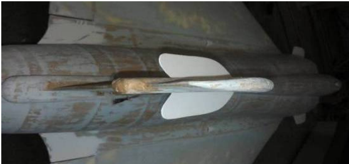
15 -Ajuster latéralement l'élément en ABS et le coller (la photo ci contre.)
