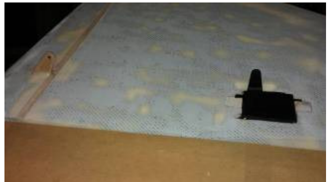
12 -placer le servo avec le palonnier bien vertical quand le servo est au neutre.
