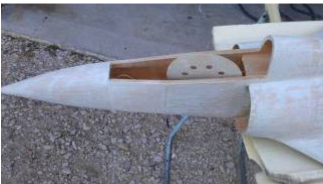
15 -Voici le devant de l'avion après ponçage.
