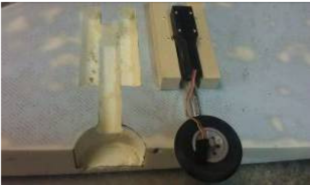
9 -Creuser le Rofmat au niveau de train comme le montre la photo.
