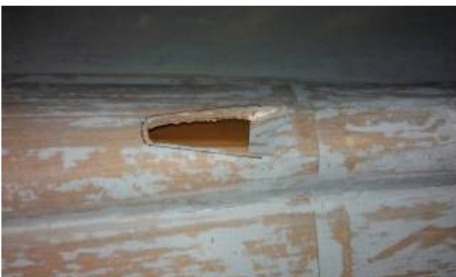
5-A 7cm du pied de dérive, réaliser une ouïe de sortie d'air pour le canal d'air du contrôleur.
