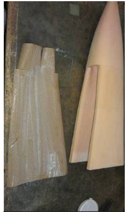
16 -Recouvrir de papier Kraft l'intérieur de la cellule avant à encoller avec de la colle blanche diluée.
