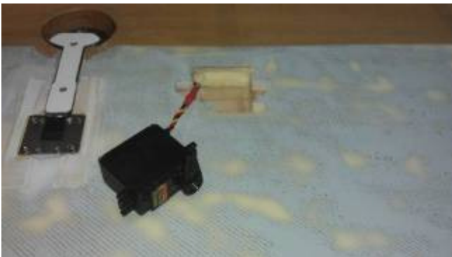
11 -Câbler le cordon servo à la rallonge en encastrant le cordon dans le Roofmate
