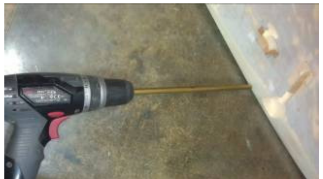
15 -A l'aide d'un tube de 10mm de diamètre faire dans l'épaisseur de l'aile un trou situé à 33 cm du bord de fuite de l'aile coté emplanture.
