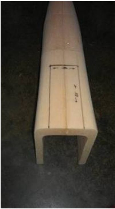
14 -Effectuer une découpe dans la cellule avant de 4cm de large centrée par 10cm de long.
