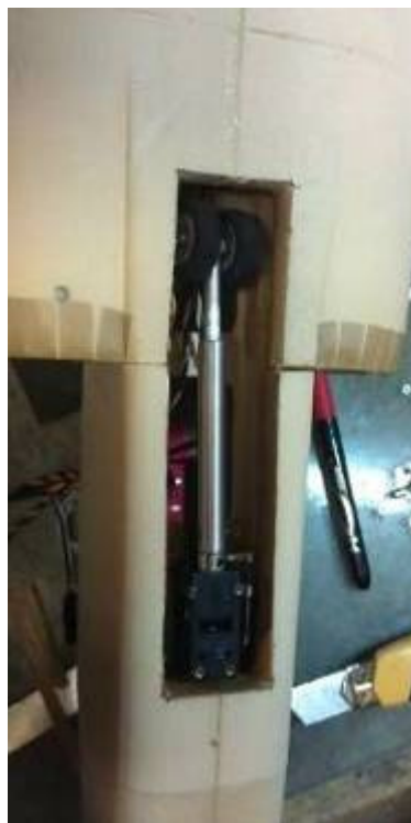
18 -Vérifier le bon fonctionnement du train cumulé avec la dérive.
