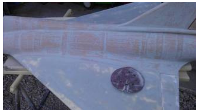
14 -Poncer généreusement pour enlever le maximum de poids.
