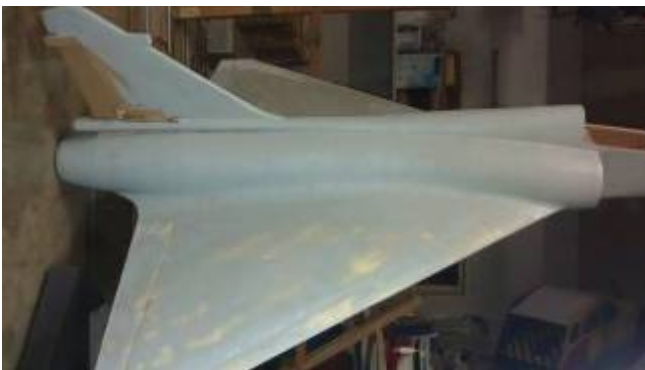
13 -Enduire d'apprêt garnissant, l'ensemble du fuselage pour faire disparaître les imperfections et les raccords de papier.
